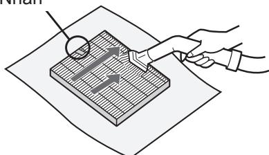
Nhẹ nhàng loại bỏ bụi bẩn ra khỏi BỘ LỌC HEPA bằng cách sử dụng một máy hút bụi hoặc dụng cụ tương tự.
